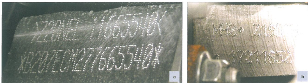
Ryc. 8a–b. Numery identyfikacyjne silnika (7a – benzynowego, 7b – diesla) – Saab 9-5
