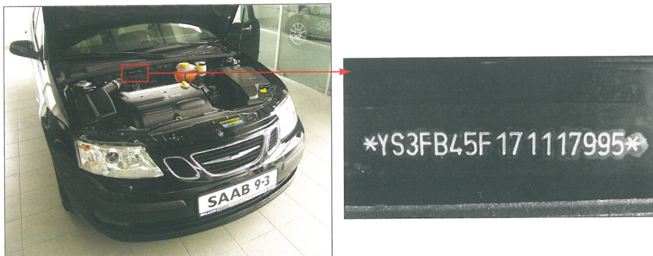
Ryc. 4. Umieszczenie i wygląd pola numerowego oraz znaki graficzne numeru VIN – Saab 9-3 Fig. 4. Saab 9-3; number field on body including graphic signs
